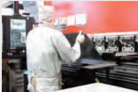
加工範囲：3000mm・90度センサーによる精度・
