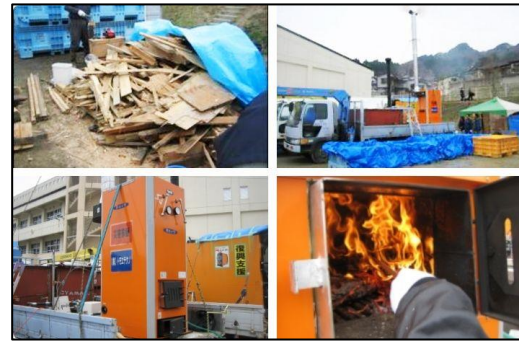
被災地支援型木材焚温水ボイラ
