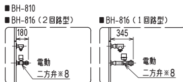
※8: 循環回路の場合、電動二方弁は付属されません。
