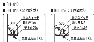
※6: 水道直結型の接続と寸法
